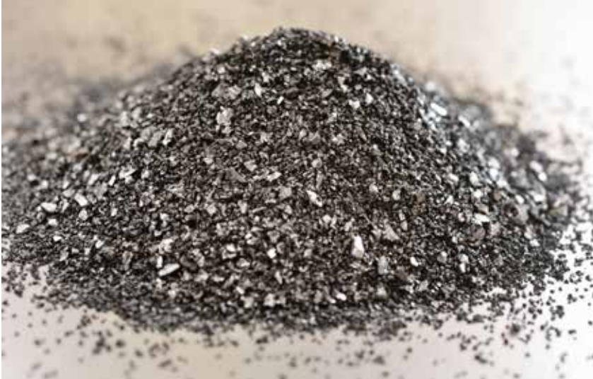
Figura 1. "Imagen que muestra el interior de un filtro de carbón activo mezclado con una resina de cambio iónico"
