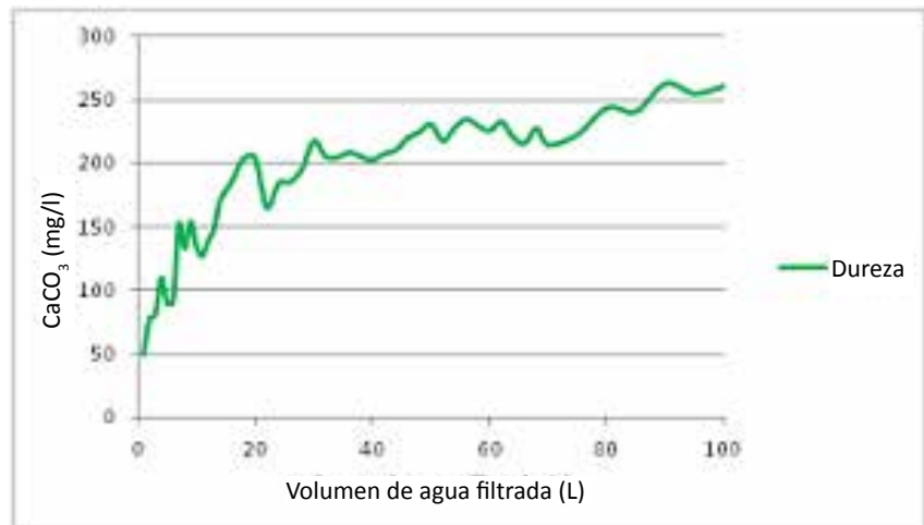
Figura 2. "Evolución de la dureza del agua tratada con la jarra filtrante con el filtro original".
